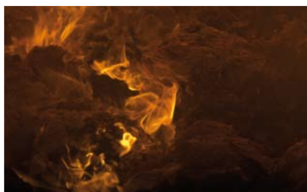
Der går automatisk ild i affaldet, når det kommer ind i den ca. 1000 grader varme ovn.
